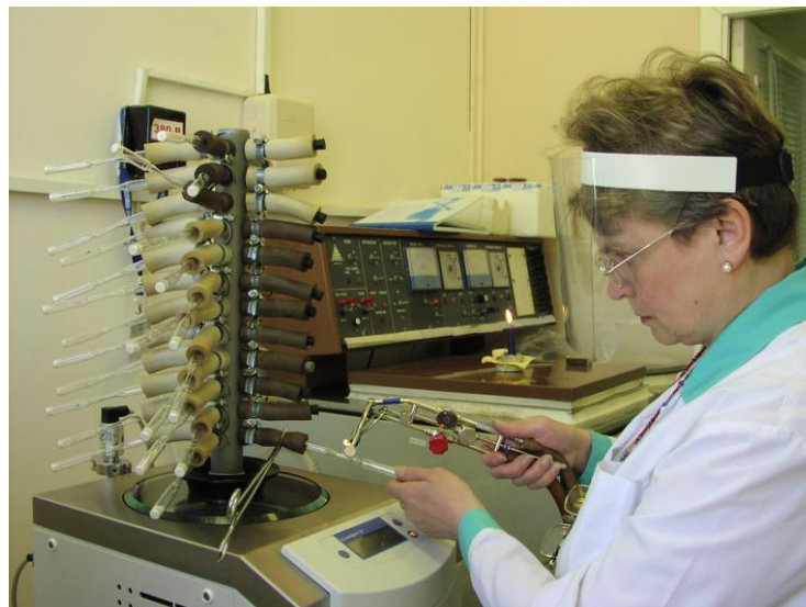
Процесс пайки ампул под вакуумом.
