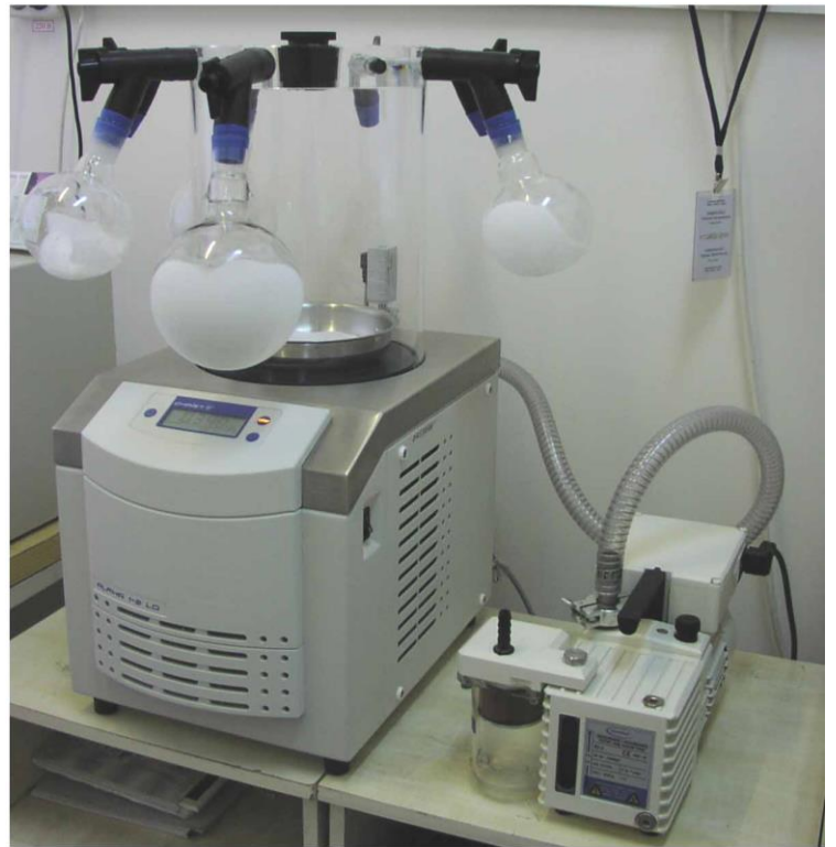
Сушка коллекционных культур методом глубокого замораживания и высушивания с использованием лиофилизатора Alpha 1-2 LD "CHRIST", Германия.
