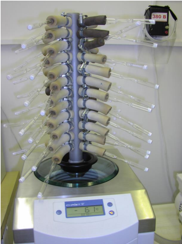
Сушка коллекционных культур методом глубокого замораживания и высушивания с использованием лиофилизатора Alpha 1-2 LD "CHRIST", Германия.
