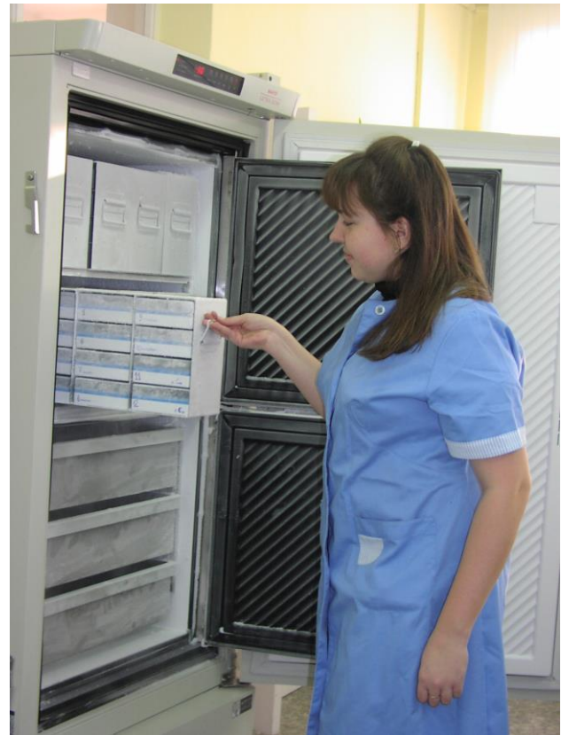
Морозильник сверхнизких температур ( -86^{\circ}\text{C} ) “MDF-U4086S” с системой “Back-up CVK-UB2”, SANYO, Япония
